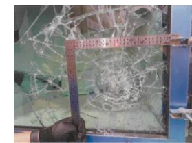
衝突部分の拡大
